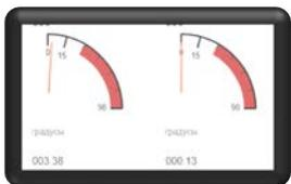
Регистрирует факт превышения порогового значения угла наклона (например, если угол наклона >3 градусов более 2 секунд передает тревогу)
