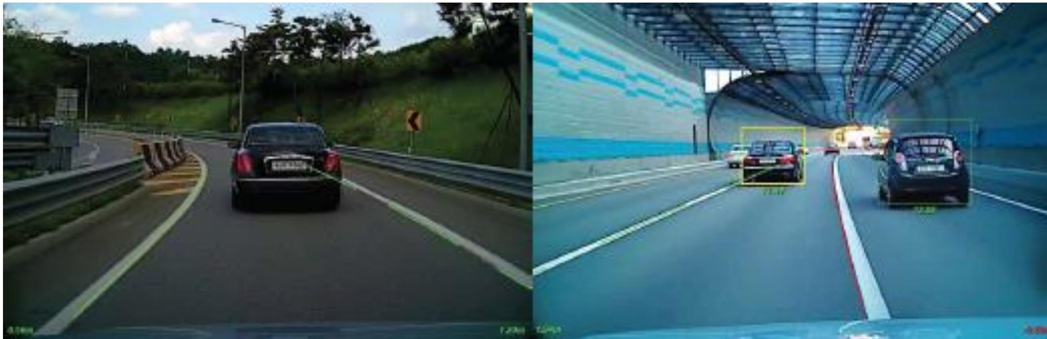
Во время движения устройство распознает параллельную разметку, прерывистую или сплошную, а также постоянно следит за соблюдением бокового интервала и пересечении линии разметки без включенного указателя поворота. При опасном приближении к линии разметки или пересечении ее без указателя поворота, устройство сигнализирует водителю и формирует тревожно сообщение для отправки на сервер.
