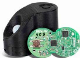
Мини PIR датчик для контроля вскрытия офисных шкафов, сейфов, входа в комнату, датчик открытия двери.
