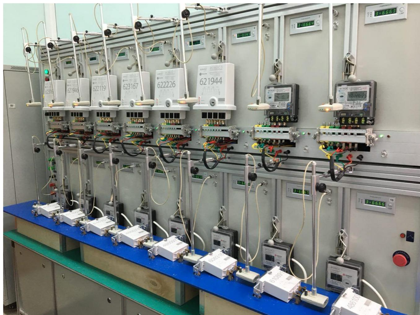
Полностью автоматические установки для одновременной многоточечной калибровки однофазных и трехфазных счетчиков электрической энергии
