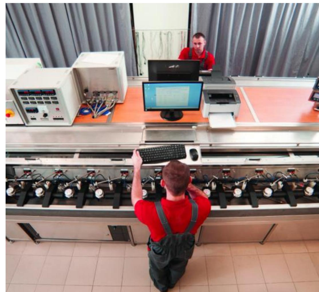
Две линии для сборки и калибровки счетчиков воды
